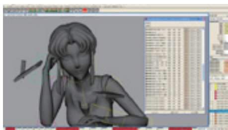
MELを使いFull BodyIKのIKで271パターンのポーズからモーションを自動生成。トータル90分のモーションが作られた
