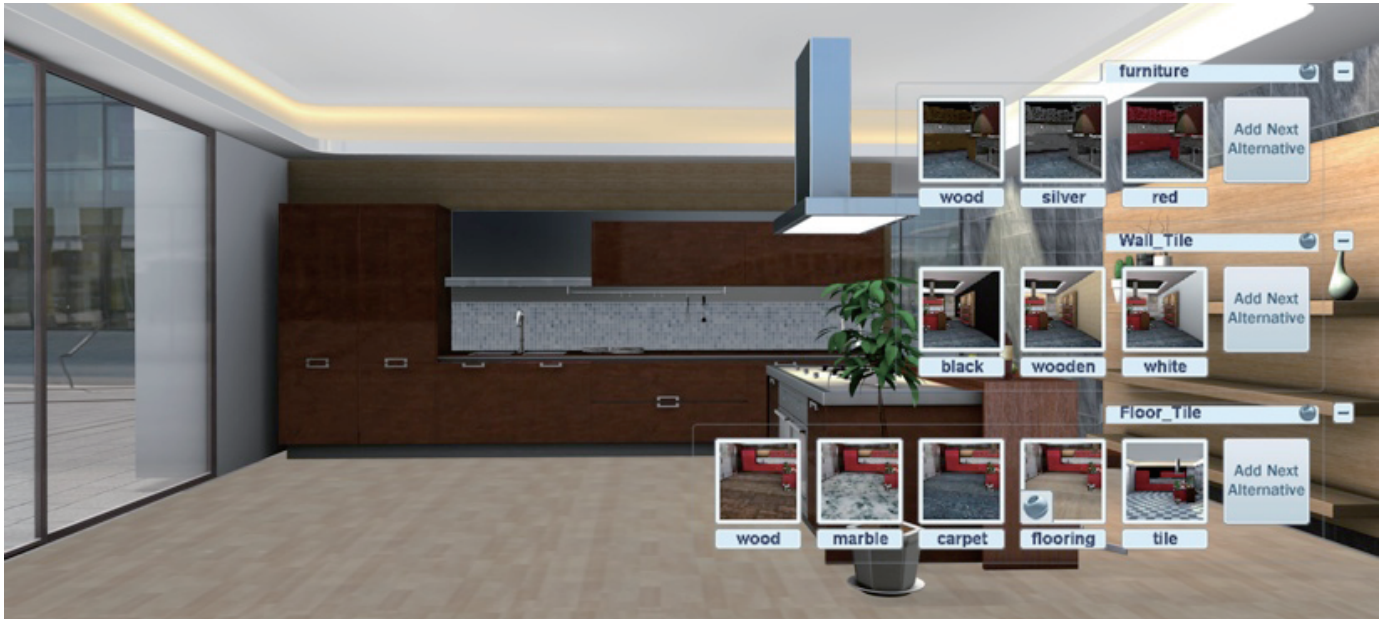
Autodesk Showcase 作業画面 部材に使用されている素材を簡単に切り替え、確認することができる。
